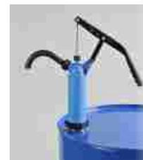
Pompa in PPL Ryton e guarnizione in teflon specifica per oli leggeri, paraffina, diesel, alcool, acqua, agenti chimici a base acqua, solventi leggeri, fluidi antigelo, soluzioni molto aggressive di acidi e alcali, acido nitrico
